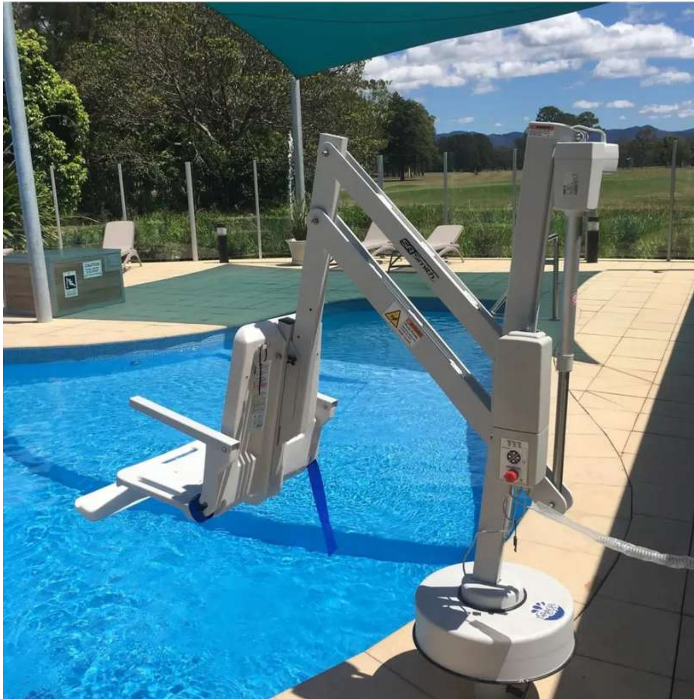
Приклад облаштування спеціального підйомника біля басейну
